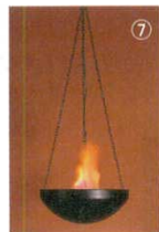
⑦ 大型吊り下げタイプ BB-205 製造中止 寸法：本体／370×370×H120 2.1kg 吊下げ時／365×365×H950 フレーム部（炎）／240×H230 3枚 材質：本体／スチール製 フレーム／シルク生地 ランプ数：3灯（12V／20W ハロゲンランプ オレンジ2個 ブルー1個） ファン数：1個 電源入力：AC100V 50/60Hz 消費電力：120W
