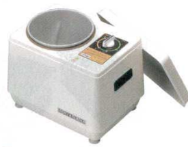
⑤生地こね機 KN-1000 エルニーダ 6944100 370×270×H300 電 源：単相100V（50 / 60Hz） 消費電力：130W 重 量：9.5kg 容 量：粉（0.4～1kg） うどん（0.4～0.6kg） ※発酵タイマー付 （スイッチ兼用60分タイマー・チャイム付） スミフロン加工のボットに樹脂製の羽根 を使用しています。 用途としてパン生地・うどん・餅などが 作れます。
