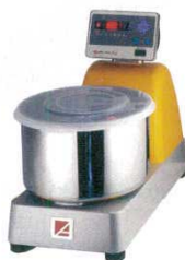
②卓上型ニーダー レディースシェフ DK-21 d 8603500 288×475×H445 電 源：単相100V （接地型2極プラグ/7A/125V/コード3m付） 消費電力：230W・モーター（3.5A・50 / 60Hz） 重 量：約20kg 容 量：9.0ℓ（脱着式・ボールカバー付） ●従来のミキサーのようにドウフックで生地を撈拌しながら練るの ではなく、ニーディングヘッドで生地をこねながら練ります。 その為グルテンを切る事が無く、生地にとっても、機械にとっ ても優しい設計です。 ●カフェ、レストランなどで少量のパン仕込みを行うのに最適です。
