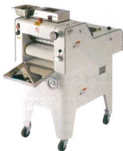
⑩製パン成形機 MM-230EB 「ミニモルダー」アイコー 6538710 500×985×H1,050 電 源：3相200V 消費電力：200W ローラー幅：230mm ローラー径：φ95mm ローラー間隔：0～15mm（連動可変式） ベルト幅：300mm 生地重量：30～350g 本体重量：100kg
