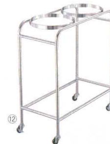
洗面器スタンド 18-8 EBM 外寸 商品コード ⑫シングルタイプ 346×346×H800 6310000 ⑬ダブルタイプ 680×350×H800 8123600 リング径：φ310 キャスターサイズ：φ40×4自在 (2ストッパー付) ※31cm～36cmの洗面器が使用出来ます。
