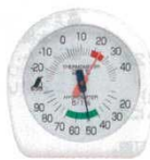
⑮ 温湿度計 チャーミー P-2 70380 120×120×H30 2933100 質量：100g 測定範囲：温度-20～40℃ (2℃) 湿度15～100% (5%) 材質：目盛板カバー/スチロール 快適温度、快適湿度ゾーンに色がついており、健康管 理や省エネに役立つ温湿度計です。 本体ケースには抗菌剤入りプラスチックを採用。
