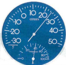
① 温湿度計 TM-108 シチズン 300×300×H39 3426200 質量：990g 測定範囲：温度-30～50℃ (2℃) 湿度0～100% (5%) 材質：枠/プラスチック 風防/ガラス製
