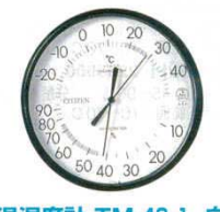
⑨ 温湿度計 TM-42-1 白 φ150 5495800 プラスチック枠 測定範囲：温度-20℃～+40℃ (2℃) 湿度10%～90% (5%)
