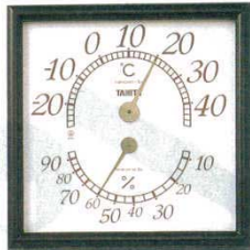
② 温湿度計 オフィスキング 5485 305×305 2935500 質量：990g 測定範囲：温度-20～40℃ (2℃) 湿度10～90% (5%) 材質：ポリスチロール、ガラス
