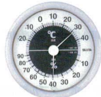
⑤ 温湿度計 TT-514 ブルー φ182×32 0859300 質量：約230g 測定方式：バイメタル式 表示方法：指針 設置：掛式 測定範囲：温度-20～40℃ (2℃) 湿度10～90% (5%)
