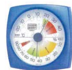
⑭ エンベックス 生活管理温・湿度計 TM-2436 132×121×H50 3426300 質量：約130g 測定範囲：温度-20～40℃ (2℃) 湿度10～90% (5%) 材質：ABS樹脂 卓上用ですが、台をとれば壁掛になります。
