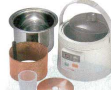
⑬マイコン電気発芽器 HP-70 発芽美人 6873400 220×240×H200 電源：単相100V 消費電力：37W 容量：1.9ℓ ●マイコン制御で発芽に最適な温度をコントロールして、22時間で活性化したおいしい「発芽玄米」に。あとはお手持ちの炊飯器で炊飯でき、 お好みの割合で白米との混合炊飯もできます。 ※「玄米」を発芽させ「発芽玄米」をつくる専用 機能です。炊飯ジャーとしては使用できません。 発芽玄米の作り方 1.本体に内なべ、発芽用銅フレームをセットします。 2.水洗いした玄米を内なべに移します。 ※玄米を7合 (1.3ℓ) 発芽させると、水分を含み 2～3割位増え1升位 (1.8ℓ) の水量になります。 3.内鍋に水を入れます。 4.発芽用ふたをして、電源ON。
