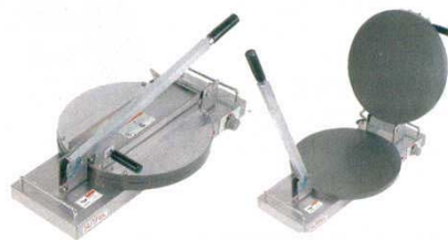
⑨ビザプレス SDP-35 8378900 外寸：350×600×H300 (蓋開時：H680) 電源：単相100V 消費電力：1,000W プレス板サイズ：φ350 ●うすく延ばすのが難しい、厚さ1～3のクリスピータイプの ピザやトルティヤ等のクラストを簡単に成型できます。 ●20秒でピザ生地を一発成型。 ●手作り本格派クリスピータイプのピザが簡単に！
