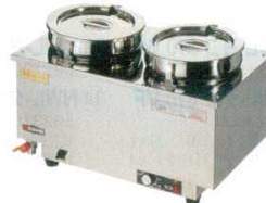
④ウォーマー ES-3W ヨコ型 電気式 18-8 エイシン 0869000 単相100V 750W 収容量: 4.5ℓ×2 (ホテルパン1/4) 温度調節: 30℃~100℃ サーマ可変式 外寸: 420×320×H300 ※タテ型のES-3WT (排水バルブ付) 0869100もあります。
