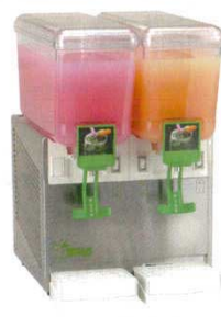
⑧ コールドドリンクディスペンサー EXTRA12.2A (2連タイプ) 5750300 外寸：360×471×H570 重量：24kg 容量：12ℓ×2 電源：単相100V 350W 冷却温度：3～7℃ 攪拌方式：パドル式攪拌
