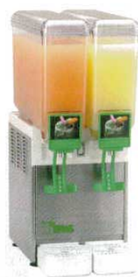
⑥ コールドドリンクディスペンサー JOLLY8.2G (2連タイプ) 5750100 外寸：246×399×H625 重量：17kg 容量：8ℓ×2 電源：単相100V 300W 冷却温度：3～7℃ 攪拌方式：横噴流式
