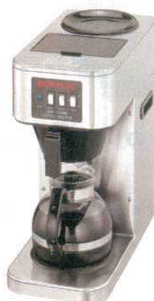
⑥ コーヒーブルーワー BM-2100 ボンマック 2904200 204×426×H446 電源：単相100V 消費電力：湯沸850W 保温100W×2 タンク容量：約3ℓ 抽出サイクル：約14分 初動沸き上がり時間：約23分 重量：6kg 使用ペーパーフィルター 25cm
