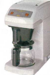
⑨ コーヒーマシン ET-250 カリタ 4014200 外寸：200×375×H420 重量：5.1kg 電源：100V/920W 50/60Hz 最大使用水量：1.7ℓ 能力：約60杯/h 使用ロシ：立ロシ25cm 付属品：ファンネル#250、1.7ℓ デカンタ 2,000cc計量カップ ●しずくで防止装置付
