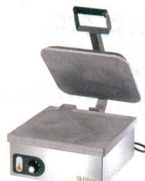
⑦ プレスサンドメーカー SP-1 1063800 外寸：355×467×H330 焼面サイズ：340×320 固定高さ調節：最大幅45 電源：単相100V 消費電力：1,250W 温度調節：サーモスタット0～300℃
