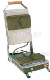
④ スナックベーカー KB-2H 電気式 0966900 単相100V 910W 本体サイズ：235×410×H160 焼板サイズ：97×97 (×2) 温度調節：サーモスタット 焼き上がり寸法：97×97 ※ベル付タイマー使用
