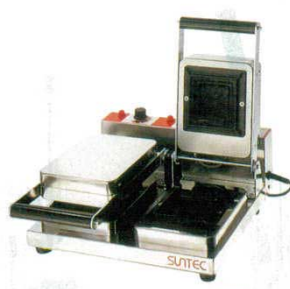
② ホットスナッカー HS-103 電気式 4549000 外寸：370×385×H175 単相：100V 1,000W タイマー：5分計 温度調節：サーモスタット 0～200℃ 焼き上がり寸法：95×95 ※特注にて単相200V、三相200Vもできます。
