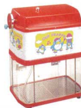
⑨電動氷削機 CFB-250 (ブロック氷専用) ストッカー付 スワン 355×580×670 3147800 重量: 32kg 定格電圧: 単相100V 50/60Hz 140/170W 処理能力: 1.8~2.5kg/分 ストッカー: 8kg 円盤有効径: φ217 ●ブロック氷専用のストッカー氷削機 ●照明付で集客力アップ ●粗さ調節ダイヤルワンタッチ
