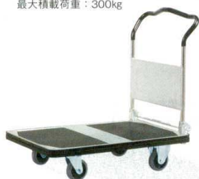
⑤台車 プレミアムダンディ (ハンドル折りたたみ式) PDA-LSC-MS 6333000 外寸：900×600×H925 材質：スチール、ゴムマット キャスター：φ125×4 (自在×2・固定×2) 最大積載荷重：300kg ※ユニバーサルデザイン採用の使いやすいハンドル。
