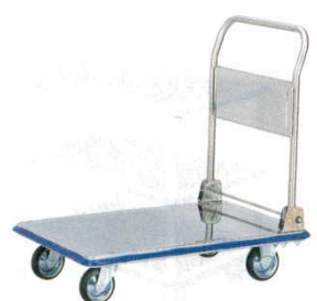
ステンレス台車 (ハンドル折りたたみ式) ⑫SS-101 外寸：740×480×H835 1240300 キャスター：ジェンゴム製φ100 (自在×2・固定×2) 最大積載荷重：150kg ⑬SS-301 外寸：910×610×H900 1240400 キャスター：ジェンゴム製φ130 (自在×2・固定×2) 最大積載荷重：300kg 材質：本体・ハンドル/ステンレス マット/塩化ビニール
