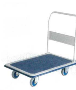
⑦台車 NHT-302 大型 (ハンドル固定式) 1028410 外寸：920×610×H880 材質：本体・ハンドル/スチール マット/塩ビ キャスター：φ130 (自在×2・固定×2) 最大積載荷重：300kg
