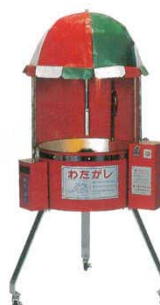
⑧ わた菓子自動販売機 CA-6型 電気式 6455500 直 外寸：730×510×H1,380 能力：1分毎に1本 重量：20kg 電源：100V 700W ※100円を入れると釜が回る。(1分20秒位)釜 が回りはじめて5秒位すると12gのザラメの 砂糖が落ちる。それを箸で取る。
