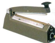
⑩シーラー PS-200 卓上型 6191600 外寸：305×77×H150 重量：2.5kg 電源：単相100V 300W シール寸法：200×2mm シール能力：0.2mmまで
