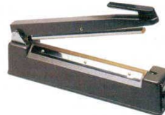
⑪シーラー PS-300 卓上型 6191700 外寸：425×85×H175 重量：3.9kg 電源：単相100V 400W シール寸法：300×2.5 シール能力：0.2mmまで
