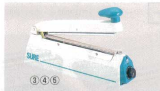
③卓上シュアーシーラー NL-101J 1126600 外寸：227×78×H170 重量：1.6kg 電源：単相100V 50/60Hz 消費電力：200W シーリング時間：0.2～1.3秒 シール寸法：2mm巾×100 ●軽いレバー操作で美しい丈夫な シールができます。
