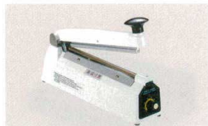
①卓上シーラー CS-200II アスパル 8445000 外寸：320×80×H150 重量：2.7kg 電源：100V 消費電力：310W シール寸法：2mm巾×200
