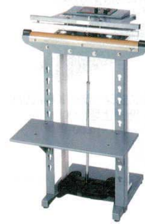
⑯足踏み式スタンドシーラー WN-300-10 7327900 外寸：340×380×H900 重量：23kg シール寸法：300×10mm 電源：100V 消費電力：1,700W シール方式：下片側加熱 ●ダブルアングル設計で米袋、肥料袋など の重袋包装作業に適しています。 ●両手で袋を持ってペダルを踏むだけ。 ●インパルス方式。
