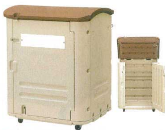
⑦ワイドストレージ 400 (400ℓ) 商品コード キャスター無し 900×680×H1,050 0658900 キャスター付 900×680×H1,110 0659000 キャスター：φ75×自在 2ヶストッパー付 ●二重パネル構造・フルオープンタイプ ●排水口、アイボルト、カギ穴付 ●45ℓゴミ袋8ヶ相当
