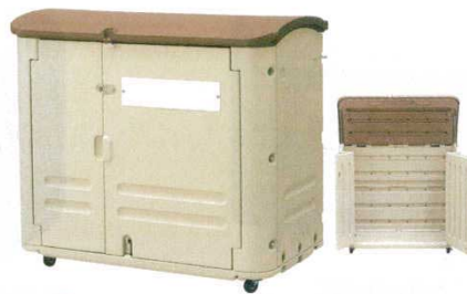
⑧ワイドストレージ 600 (600ℓ) 商品コード キャスター無し 1,250×680×H1,050 0659900 キャスター付 1,250×680×H1,110 0660000 キャスター：φ75×自在 2ヶストッパー付 ●二重パネル構造・フルオープンタイプ ●排水口、アイボルト、カギ穴付 ●45ℓゴミ袋13ヶ相当
