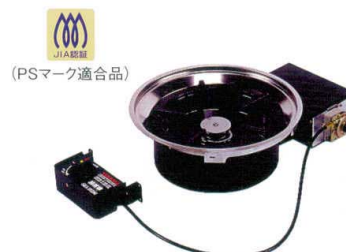
5 器具ユニット(鍋用) CTK-2020 c LP ¥74,000 13A ¥74,000 燃焼器寸法:W490×D380×H145mm ガス消費量:LPG 4.07kW (0.29kg/h) 13A 4.07kW (3500kcal/h) 点火方式:連続放電点火方式 天板開口寸法:φ348mm ガス接続口:LP・13A:9.5mmホース用ホースエンド 安全機能:立消え安全装置付 使用可能最大鍋径:30cm
