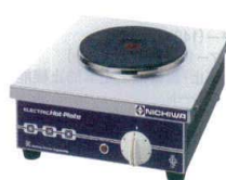
7 電気コンロ THP-2 [EDKO-07] 11-0272-0701 ¥51,000 サイズ:300×340×H120 重量:6kg 単相200V 1.7kW ヒーターサイズφ190 リード線2m・引掛プラグ付き 接地2P・20A③
