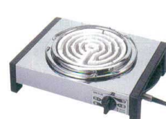
11 シュアー 電気コンロ SK-65 [EDKO-16] 11-0272-1101 ¥5,000 サイズ:290×220×H85 重量:1.3kg 消費電力:単相100V 600W コード長さ:1.8m スイッチ:3段階切替(切・弱・内)300W・弱 (外)300W・強600W)
