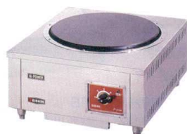
13 電気コンロ NK-6000 [EDKO-11] 11-0272-1301 ¥265,000 サイズ:500×570×H250 重量:35kg 電源:3相200V 消費電力:6kW 温度調節:2.6, 4.1, 6kW, 3段切換式
