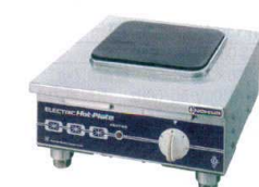
9 電気コンロ THP-3 [EDKO-09] 11-0272-0901 ¥120,000 サイズ:350×400×H170 重量:9.5kg 単相200V 2.2kW ヒーターサイズ220×220 リード線2m・引掛プラグ付き 接地2P・20A③
