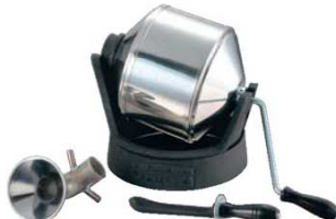
④ 手動 焙煎機 サンプルロースター 0956400 外寸:480×230×H250 重量:5kg 容量:400~500g 付属品:じょうご、テストスプーン ※家庭用ガスコンロで御使用可能です。 火加減は中火以上で1分間に40~50回転 させて下さい。
