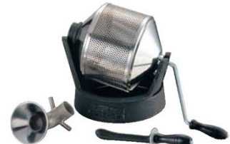
③ 手動 焙煎機 サンプルロースター (パンチング) 0956300 外寸:480×230×H250 重量:5kg 容量:400~500g 付属品:じょうご、テストスプーン ※家庭用ガスコンロで御使用可能です。火加減は中火 以上で1分間に40~50回転させて下さい。直接火が 当たりますので焙煎度合を調節できます。
