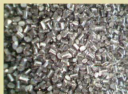
回収した PBT 樹脂箸を粉砕し一級品の材料を加えペレット化する。
