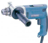
8 電動ドリル DP4002 [BDDL-03] M 11-0085-0801 ¥26,900 全長:304 電源:単相100V 50/60Hz 消費電力:710W 回転数:毎分0~600回転 チャック能力:2~13mm 重量:2.2kg コード長さ:2.5m ●正逆転切り替えレバー付 ●スピードをコントロールできる無段変速付です。
