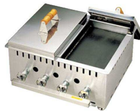
⑦ EBM 角 ギョーザ焼器 ダブル ジェットバーナー使用 鍋材質:鉄(厚さ12mm) 蓋材質:18-8ステンレス
