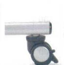
アジャスト機能付キャスター キャスター上部のリング により高さが調節できま す。制動力の高いリフト ロック式ストッパーです。
