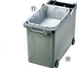
⑩ 強化耐熱プラスチック フライヤー用 油缶 (カゴ付) ㊦ 5622500 ¥23,000 外寸:275×550×H335 容量:30ℓ 耐熱温度:265°C 材質:本体・キャスター/ナイロン66GS 把手部/ステンレス製
