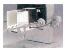
②ウェートとコンベアーの間にネギを差し込む(なるべく奥まで) ③ジョイントワイヤーを厚み調整の任意の番号にセットする。スイッチを押す(電動)またはハンドルを回す(手動)とネギが自動に送り込まれ設定した厚みにネギが切れます。
