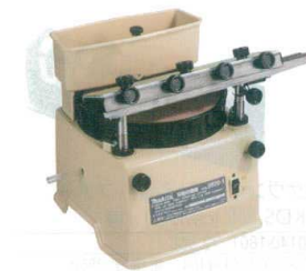
スロット2: 中研ぎ スロットのみの使用で手軽に研ぐ事が出来ます。ダイヤモンド研磨剤使用
