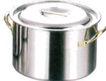
大きく見やすい目盛 筒状の取手なので握りやすくソフトタッチです。 蓋の置場にこもらない引掛金具付の蓋です。 取手部分は18-8ステンレスパイプに金メッキがほどこされています。 内層に熱伝導のよい普通鋼を使用した三層構造。
