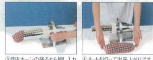
③ 肉をホーンの後方から押し入れ、付属の突き棒で押し出します。
