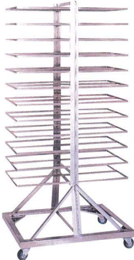
③ 6取トンボラック24枚差 オールステンレス [DTRK-04] 13-0548-0301 サイズ: 800×530×H1,700 羽根有効: 350×370 棚有効: 90 車輪: φ100×4自在 重量: 48kg 材質: SUS430、羽根はSUS304を使用 ※8取天板も使用できます。
