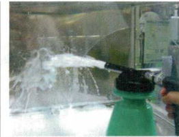
※ スプレーヤーの噴射口から洗浄対象面までの適切な距離は50cmです。(水圧によっても変わります)
