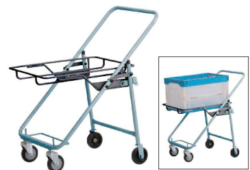
⑩ モデアカート 02 水色 (折りたたみコンテナ50ℓ用) 全品直送 全量 3~5日 運賃別途 〈AKC-38〉 9-0174-1001 ¥26,400 547×697×H861 荷台内寸法:556×420×H40 本体:スチール焼付塗装 車輪:ゴム製φ100×2自在φ100×2固定 積載荷重:80kg ●規格のコンテナ類を下に収納でき、荷物の積み下ろしが楽にできます。 ●折りたたんで収納でき場所を取りません。
