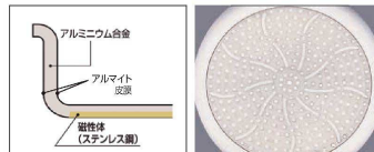
本体アルマイト加工 底面ステンレス板圧着
