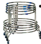
⑤ 18-0丸型ざる置台 SK-55 〈HZL-02〉 9-0276-0501 ¥32,000 φ550×H600 上径内寸:φ508 キャスター:φ50×3自在 耐荷重:50kg
