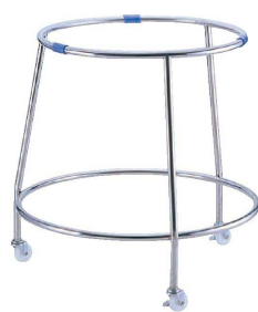
① 18-8丸型ざる置台 〈AZL-37〉 9-0276-0101 ¥24,000 φ550×H650 上径内寸:φ508 キャスター:φ50×3 自在 (ストッパー付×2) (ストッパー無×1) 耐荷重:50kg
