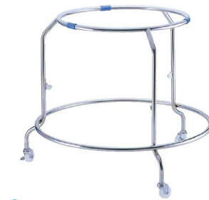
③ 18-8丸型ざる置台 ドライタイプ 〈AZL-38〉目 9-0276-0301 ¥38,000 φ550×H650 上径内寸:φ508 キャスター:φ50×3 自在 (ストッパー付×2) (ストッパー無×1) 水受けサイズ:φ600 耐荷重:50kg ●P.255・256のボール60cmがセットできます。(別売)
