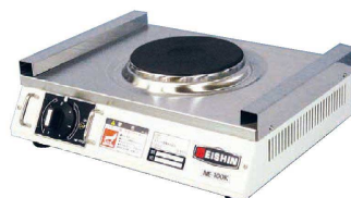
② 電気コンロ NE-100K (DKV-13) 9-0725-0201 ¥60,000 370×300×H100 電源・消費電力:単相100V、1kW 温度調節:6段切換式
