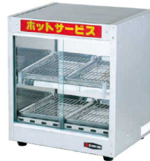
3 ホットショーケースED-6 (加湿機能内蔵) 〈EHT-09〉 9-0827-0301 ¥92,000 400×300×H460 電源:単相100V・430W 温度調節:30~85℃(サーモ可変式) 扉開閉方式:両面スライドガラス 付属品:ケーキバット10インチ4枚 網21枚取4枚
