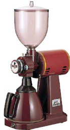
5 ハイカットミル タテ型 〈FML-15〉目 9-0906-0501 ¥120,000 178×370×H595 電源：単相100V/400W 50/60Hz 能力：500g/分(中挽) 質量：1.2kg 容量：ホッパー1,000g 粉受800g 定格時間：10分 カッター：グランドタイプ
