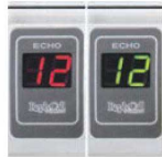
受信機に信号が届くとLEDの表示が赤から緑に変化します。
