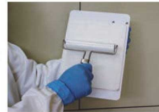
付着したゴミを転写台に移す 上から下にローラーを一度転がせばゴミが転写されます
