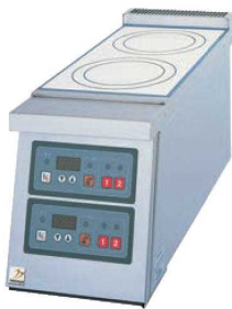
⑦IHマルチコンロ 74 直A 納期 ページコード 商品コード 価格 FIC23602A 4-0803-0701 2145310 ¥413,000 外寸:230×600×H300 IHユニット:1.3kW×2 電源:単相200V 総合消費電力:2.64kW 定常時最大電流:15A 重量:19kg コンセント形状 対応鍋底サイズ:φ150~φ180 ●必要な電力だけを使用する省エネ設計 ●金メッキ設計です。 ●清掃しやすい構造です。 ●プログラム調理と手動調理の両方が可能です。
