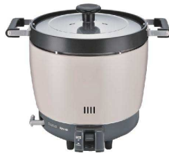
② リンナイ ガス炊飯器 RR-200CF (2升炊き・フツ素釜) [EGSA-44] LP 13A 17-0372-0201 17-0372-0202 ¥49,900 サイズ:446×334.5×H374 重量:6.8kg 炊飯能力:1.4～3.6ℓ (1.2～3.0kg) 接続寸法:φ9.5ガス用ゴム管 ガス消費量:LP/4.71kW 13A/4.88kW 点火方式:連続スパーク点火(単2電池×1使用)
