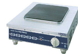
10 電気コンロ THP-4 [EDKO-10] 17-0386-1001 ¥182,000 17-0386-1002 ¥182,000 単相200V 3相200V サイズ:450×500×H170 重量:12kg 消費電力:3.0kW ヒーターサイズ:300×300 温度調節:単相/6段階 三相/3段階 リード線2m・プラグ付き (単相)接地2P・20A 引掛◎ (三相)接地3P・20A 引掛◎
