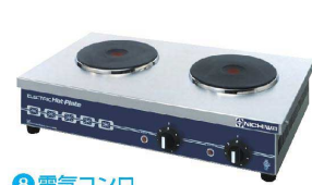
8 電気コンロ THP-2W [EDKO-08] 17-0386-0801 ¥114,000 サイズ:580×340×H120 重量:12kg 電源・消費電力:単相200V 3.0kW ヒーターサイズ:φ190×2 温度調節:6段階 リード線2m・引掛プラグ付き 接地2P・20A◎
