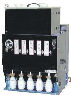
⑤ガス 自動 酒燗器 「お燗番」 GNT-5 ページコード 商品コード 価格 LP 5-1098-0501 4296310 ¥800,000 13A 5-1098-0502 4296320 ¥800,000 採酒口:5ウェイ 能力:120本/6分間 ※温度:30℃～93℃可変 ●バーナーの取付位置を左横に取付けすることが可能のため奥行の少ないスペースへの設置ができます。
