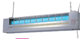
⑤ 屋内用 ビオニー 捕虫器 ㉙ ページコード 商品コード 価格 G-201型 5-2086-0501 8490000 ¥37,100 685×95×H120 重量:2.7kg 電源:単相100V 有効面積:40~60㎡ 捕虫方法:捕虫紙粘着方式 誘虫ランプ:20W(FL-20SBL) 材質:ステンレス(SUS 304) 捕虫紙:1枚入り 捕虫テープGC-20S(20枚入) 5-2086-0502 8490010 ¥6,200 ㉙
