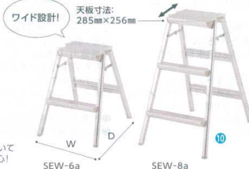
9 アルミ踏台 SE型 [KHMD-09] ◇ 最大使用質量 100kg 天板高さ (m) 重量 (kg) 設置寸法(外寸)(mm) 収納寸法(外寸)(mm) W D 全長 W D SE-6a 0.56 1.8 430 500 600 430 180 SE-8a 0.79 2.6 470 660 850 470 180
