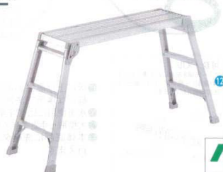
12 アルミ足場台 DRX-1075C [KHMD-10] 最大使用質量 100kg 18-0751-1201 ¥27,900 天板高さ:0.75m 天板有効寸法:1,000×300mm 重量:5.2kg 設置寸法(外寸):440×1,420mm 収納方法(外寸):1,030×440×H180mm ●収納時は脚部が折り畳み構造なので、コンパクトに収納できます。
