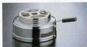
⑨ チューフィング500 (ウォーマー) φ125×H60mm (5552100) ※反応剤メタ500は別売です。 ⑩をご使用下さい。 (使用方法) ●本体にフタをはずした反応剤メタ500を セットする。 ●一度燃してメタ500に着火する。 ●着火したメタ500で本体内部を暖める。 ●メタ500の炎を缶フタを裏返して消火する。 ●本体にメタ500をセットする。 ●ウォーターパンの高さや料理の種類に合 わせてチューフィング500の本体の高さ を調節することができます。
