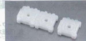
⑫ 保温材 ホットブロック (1693400) 外寸: 115×115×H30mm 材質: 容器/耐熱ポリプロピレン(PP複合材)、 内容物/ポリエチレングリコール10000 ●保温力: 約55℃～60℃ (約2～3時間) ●使用方法: 熱湯に20分 (90℃のお湯に 弱火で煮沸) ※用途に応じて複数個つなぎ合わせて仕様 面積を拡張出来る連結タイプです。
