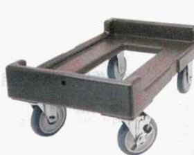
⑭ ピザ生地ボックス用カムドローリー CD1826PDB (4134300) 外寸: 700×498×H268mm 内寸: 630×430mm キャスター: φ127×2自在 (内1個ストッパー付) φ127×2固定 積載能力: 136kg 材質: ポリエチレン
