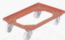
⑭ サンキャリー 2B サンコー 外寸: 582×397×H143mm (4862200) 5 キャスター: φ85mm 4輪自在ストッパー 無し ウレタン製 耐荷重: 120kg 材質: ABS樹脂 ※①クリスタル番重、③ABS塗番重A・B 型に合います。
