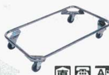
⑯ コンテナドーリー SK-23D(ステンレス仕様) (1026600) 外寸: 670×450×H150mm 内寸: 620×400mm キャスター: φ75mm ゴム製 4輪 自在ストッパー無し 材質: ステンレスフレーム 積載能力: 100kg ※コンテナサイズに応じて別注も 承ります。
