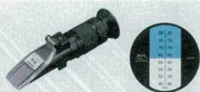
4 濃度計 N-4E 手持屈折計 外寸: 40×40×H140mm (0415500) 測定範囲: Brix45~82% 最小目盛: 0.2% 用途: 中濃度から高濃度までの広い測定範囲をもったタイプです。煮豆・コンデンスミルク・5倍以上の濃縮果汁・ジャム・マーマレード・漬物などにご利用下さい。
