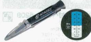
13 濃度計 MASTER-α 屈折計 自動補正式 外寸: 33×33×H204mm (8368600) 測定範囲: Brix0~32% 最小目盛: Brix0.2% 用途: 室温のサンプルなら、温度を気にせずに正しい測定ができるモデルです。測定範囲や最小目盛は手持屈折計N-1Eと同じです。10~30℃の範囲で自動温度補正が働きます。
