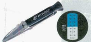
2 濃度計 MASTER-2T 手持屈折計 外寸: 75×55×H210mm (0415300) 測定範囲: Brix28~62% 最小目盛: 0.2% 用途: 中濃度のサンプルに適したタイプ。濃縮果汁・煮豆・缶詰・きんとんなどにご利用下さい。 ※自動温度補正機能付 (10~30℃)
