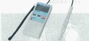
16 水分チェッカー SK-940A 外寸: 62×24×H148mm (0835900) 質量: 140g(電池除く) 測定方法: 電気抵抗式 測定範囲: 9.0~40.0% 使用電池: 006P (9V) 1コ 用途: 農産加工品、めん類、菓子類、粘土、水産加工品などの水分チェックにご使用になれます。
