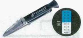
14 濃度計 MASTER-2α 屈折計 自動補正式 外寸: 75×55×H210mm (8368500) 測定範囲: Brix28.0~62.0% 最小目盛: Brix0.2% 用途: 温度補正装置を用いる手間が省け、いつでも正しい測定ができます。醤油・ソース・ケチャップ、たねなどの調味液や、低糖ジャムの測定に便利です。 ※煮詰めながら製造している高温サンプルをそのまま測定することはできません。 ※防水機能付
