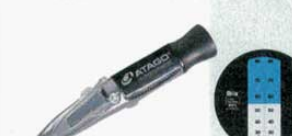
9 濃度計 MASTER-H80 手持屈折計 外寸: 33×33×168mm (8368700) 重量: 120g 測定範囲: Brix30.0~80.0% 最小目盛: Brix0.5% 耐熱強化、防水機能、自動温度補正機能 用途: H-50と同じ耐熱性を強化したタイプです。ジャム・マーマレード・餡などの測定に適しています。強化プリズムの採用により、ジャムなどに含まれている酸による腐食を抑え、寿命が長くなりました。
