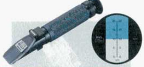
15 濃度計 ATC-20E 屈折計 自動補正式 外寸: 40×40×H200mm (8368400) 測定範囲: Brix0.0~20.0% 最小目盛: Brix0.1% 用途: 手持屈折計N-20Eをベースにした自動補正式モデルです。室温を気にせず、いつでも正しい測定ができます。果実類のBrix測定に便利です。
