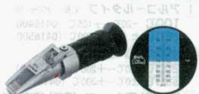
8 手持屈折計(耐熱濃度計) H-93 外寸: 40×40×H140mm (8339100) 測定範囲: 53~93% 最小目盛: 0.5% 付属品: 高粘度サンプル用ツマミ付 用途: ジャム、マーマレード、船など煮詰めながら測定する高粘度サンプルを対象に耐熱性はかっています。また、ジャムなどに含まれている酸による腐食を抑えるために強化プリズムを採用しています。
