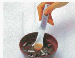
⑤塩分計 No.6302 防滴タイプ しおみスプーン タニタ 外寸: 本体28×160×13mm (4215500) 測定範囲: 0.6~1.2% (ホット専用) 表示方法: 3段階式 0.6~0.8%、0.9~1.1%、1.2%~ 電源: LR44タイプ電池3個内蔵
