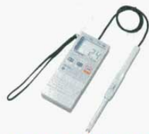
①塩分濃度計 SK-10S 外寸: 82×24×H148mm (0837500) 質量: 140g (電池除く) 測定方法: 電気抵抗式 測定範囲: 0.1~10.0% 使用電池: 006P (9V) 1コ
