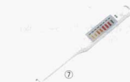
⑦デジタル塩分計 SA-01 外寸: 212×24.8×15.4mm (4798100) 重量: 36g 測定範囲: 0.3~2.0% 表示: 7段階LED表示 測定液体温度: 60~80℃ 材質: ABS樹脂(本体)/銅(センサー) 消費電力: 最大20mA (全LED点灯時) 電源: LR-44 (1.5V) ボタン電池4個 付属品: 電池(LR-44 1.5V)×4、取扱説明書 ●スイッチを押すだけのお手軽に操作。 ●分かりやすい電池交換ランプ付。
