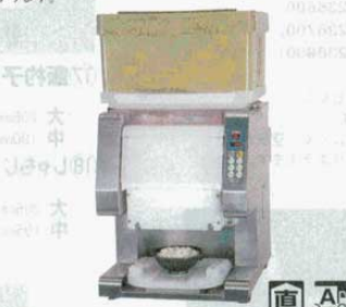
⑧ 飯盛り達人 (計量ディスペンサー) GRK-1 (1203300) 外 寸: 390×440×H740mm (保温ボックス上まで) 消費電力: 100V 200W 生産能力: 250g 約3秒 350g 約4秒 盛付仕様: 100~500g 6種類 ●ボタン一つでお好みの量のご飯が盛れます。 ●食堂やレストランで大助かりの一台です。 ※別途、設置費がかかります。
