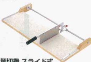
⑥ 麺切機 スライド式 麺台寸法: 幅970×奥行280mm (0582700) 刃渡/270mm ※うどん・そばなど、お好みの太さに均一に どんどん切る事ができます。
